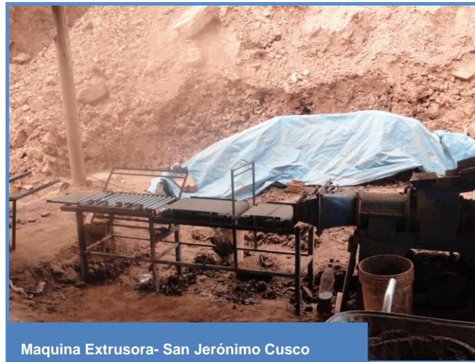
Figura 5-3: Producción de Ladrillos Mecanizados
