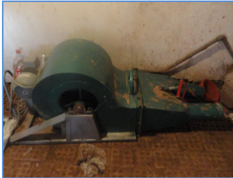
Figura 5-4: Máquina Ventiladora usada para la cocción de ladrillos.
