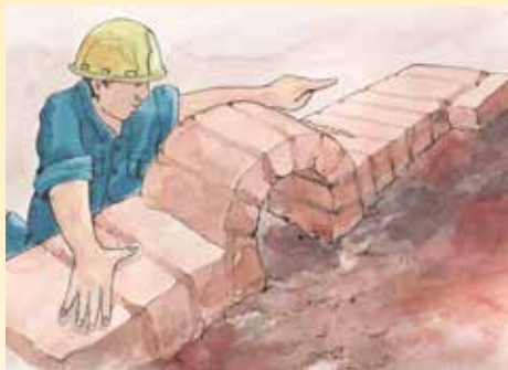
Arco de chimenea
