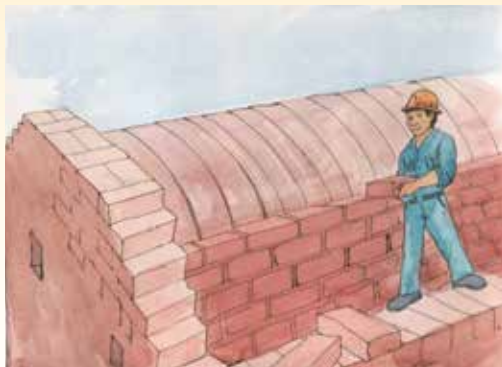
Armado de bóveda con dovelas
