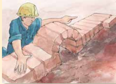
Arco de chimenea
