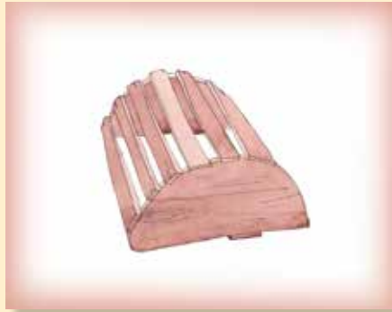
Estructura para construir el arco del ducto de evacuación de gases
