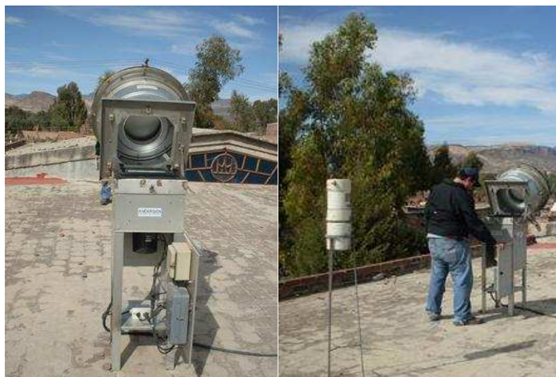
Figura 2. Equipos de monitoreo de partículas suspendidas en la comunidad de ladrilleros El Refugio en el municipio de León de los Aldama, Guanajuato.
